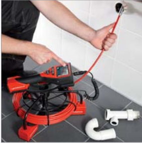
İlavabo drenaj boru kontrol
